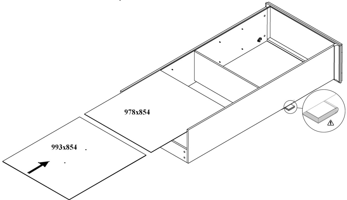
4. При помощи эксцентриковых стяжек и шкантов установить крышку, планку верхнюю крепить к крышке саморезами 3,5x25. Снизу основания установить регулируемые опоры.
