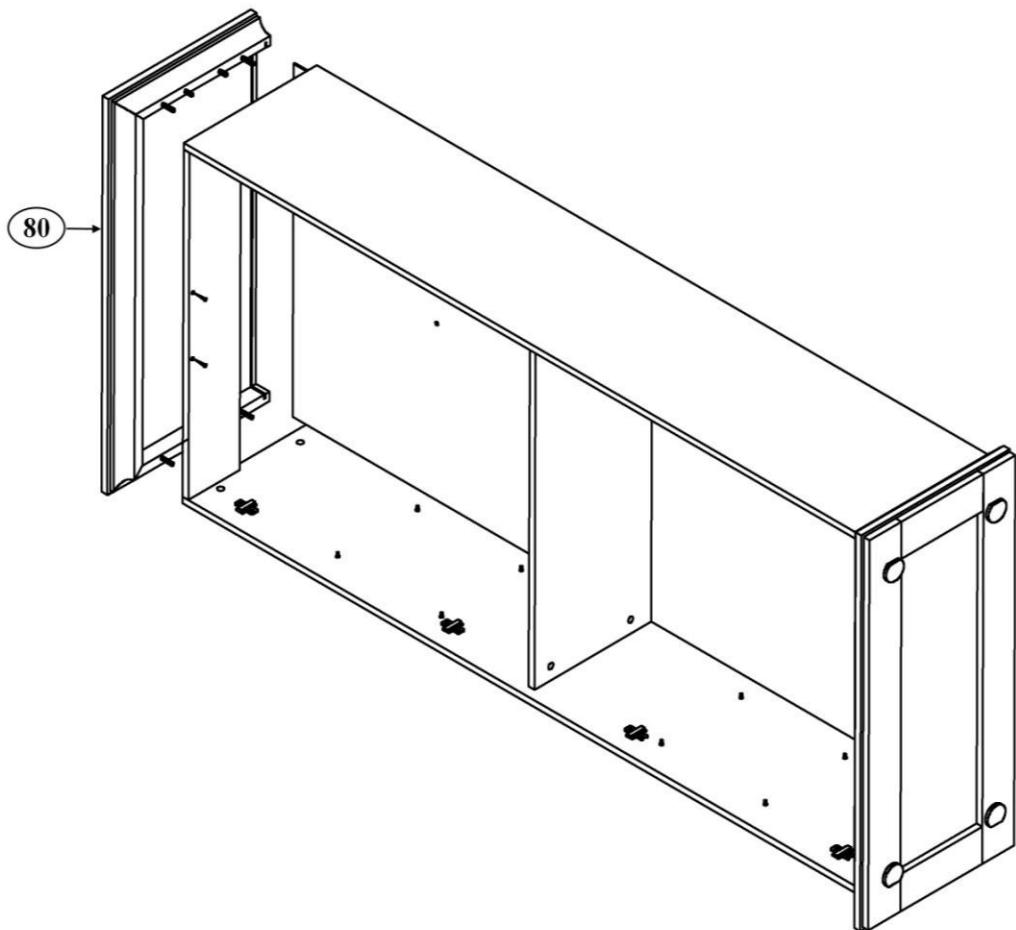
5. Собранный корпус проверить на прямоугольность, сравнивая диагонали (их длины должны быть равны). Прямоугольное положение корпуса зафиксировать, установив уголки мебельные с шурупом. Места соединения задних стенок закрепить шурупами 3x20 через скрепки.
