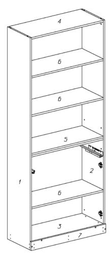
Если стеллаж будет примыкать к другим изделиям из серии, то на стенке вертикальной со стороны примыкания для межсекционной стяжки необходимо досверлить насквозь отверстия диаметром 5 мм и зенковать их для винта с потайной головкой.
