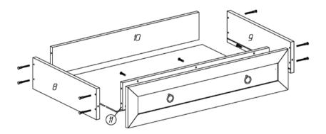
Привернуть боковые стенки ящика к передней и задней стенкам при помощи конфирматов 7х50. Пазы боковых стенок должны быть ориентированы внутрь ящика. Вставить дно в пазы, привернуть его шурупами 3х20 к передней и задней стенкам.
