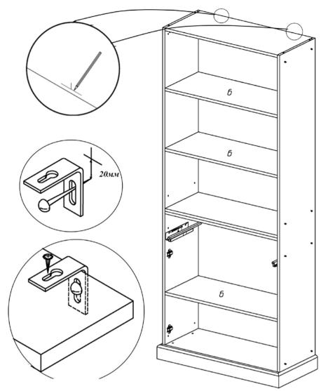
ВАЖНО. Шкаф необходимо фиксировать против опрокидывания с помощью двух подвесок и саморезов 4,2х13 с пресс-шайбой.
