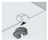
8. На стенках вертикальных *1*, *2* в отверстия диаметром 15 мм вставить эксцентрики. На карнизе, выбранном для вашей композиции, в отверстия диаметром 5мм на профилях ввернуть дюбели DU 232. Установить карниз на стеллаж так, чтобы дюбели стяжек вошли в соответствующие им отверстия. Затянуть эксцентрики, повернув их на 180 градусов.
