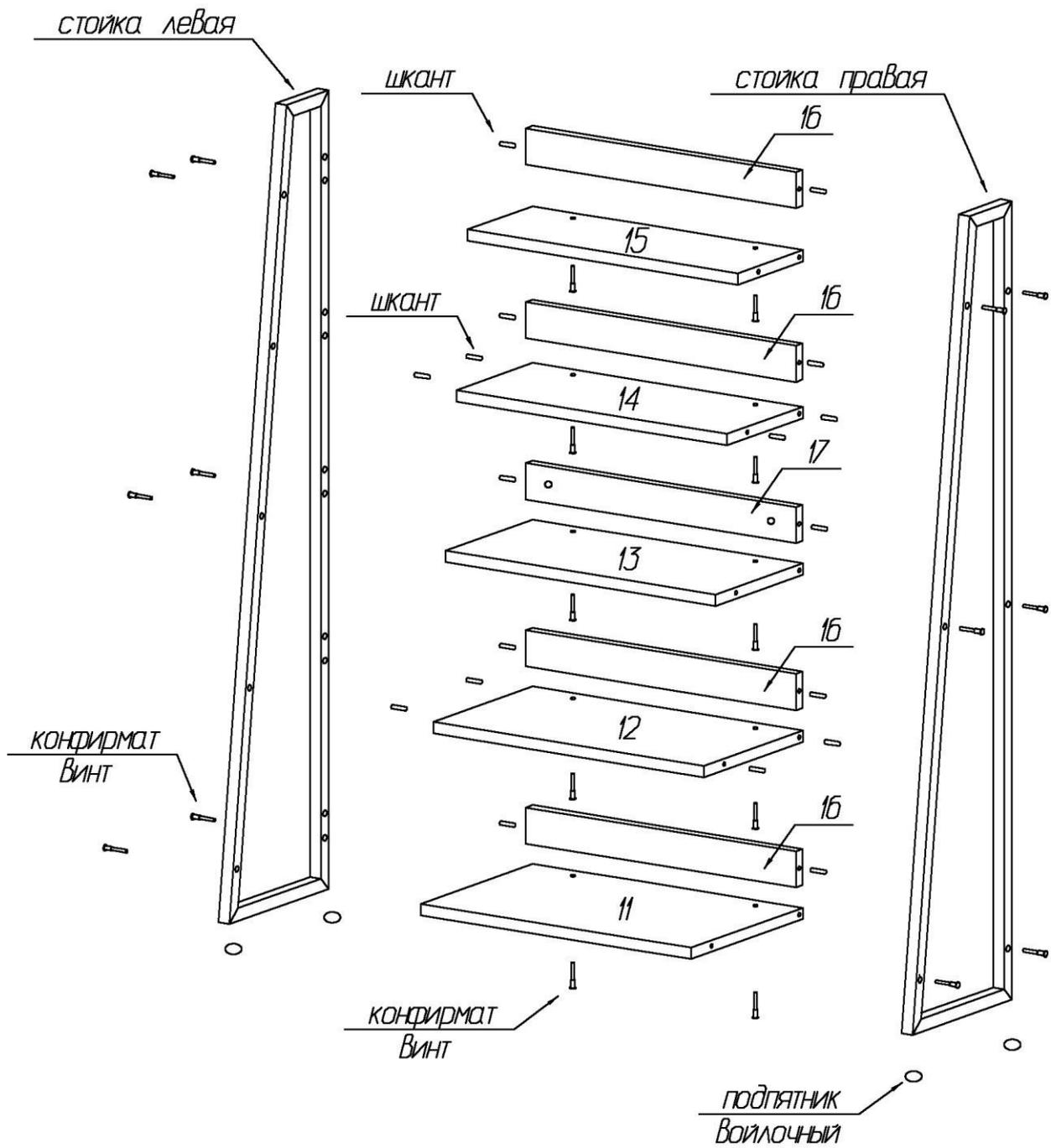
Во избежание опрокидывания необходимо закрепить стеллаж к стене. Стеллаж крепится к стене шурупами 4x50мм, которые вворачиваются сквозь отверстия в задней стенке (7) или (17) в дюбели, установленные в предварительно просверленные отверстия в стене.
