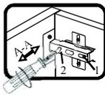
Если створка наклонена вправо или влево относительно вертикали корпуса, нужно выправить наклон створки в направлении А-А винтом 2.
