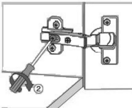
По завершении регулировки глубины двери затягивается винт.
