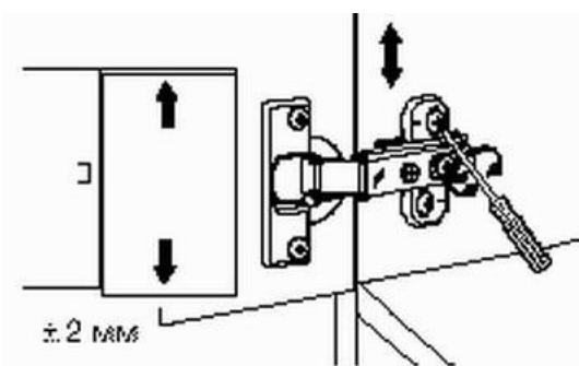
Регулировка по глубине:
