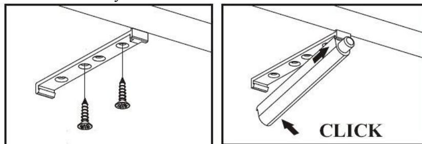
На щитовых дверях с помощью шурупов 3,5x13мм закрепить петли Slide-On.
