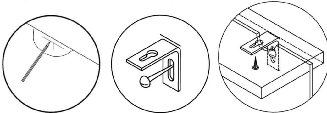
Предлагаемые дюбели предназначены для использования в стенах с полнотелыми кирпичами, силикатными полнотелыми кирпичами, бетоном или клинкерными кирпичами. Для крепления на стенах из другого материала следует использовать имеющиеся в продаже специальные крепежные элементы.
