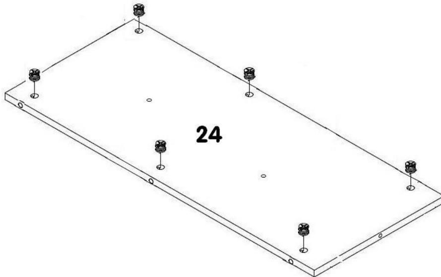
Установить стенку заднюю **24** между перегородками **25** и **26** так, чтобы дюбели стяжек вошли в предназначенные для них отверстия. Затянуть эксцентрики, повернув их на 180 градусов.
