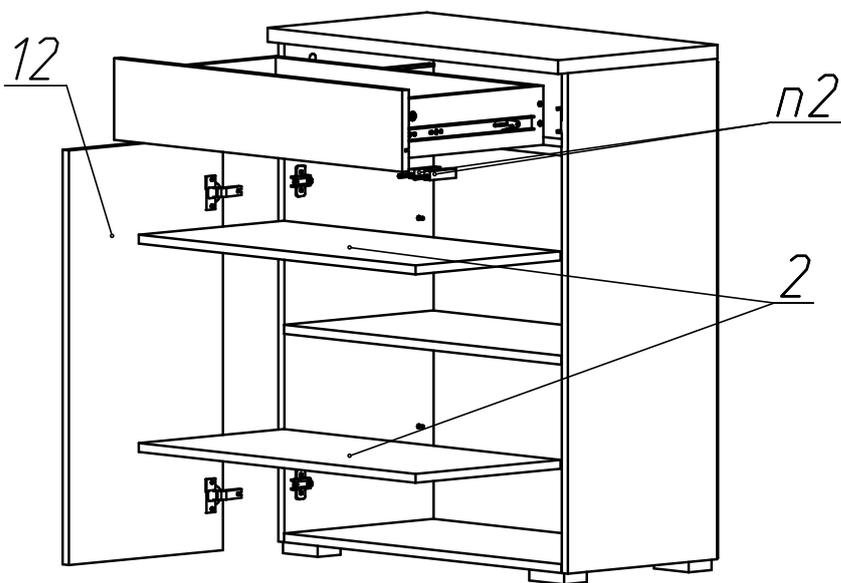
Установите и закрепите фасады Деталь №12. (правый фасад условно не показан). Установите в модель ящик, равномерно надвигая по направляющим до упора и фиксации. Поставьте в ответную часть нажимные толкатели поз.2. Установите полки Детали №2. Закройте головки евровинтов поз.1 и эксцентриковых стяжек поз.6, декоративными заглушками поз.3 и поз.7.
