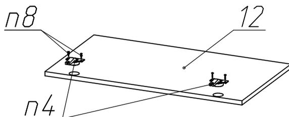
На планку Деталь №9, саморезами поз.8, закрепите ответную часть нажимного толкателя поз.2.
