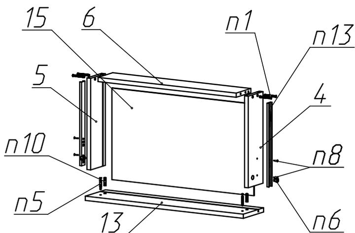
Установите на фасад ящика Деталь №13 штоки эксцентриков поз.5 и шканты поз.10. Саморезами поз.8 закрепите внутреннюю часть направляющих поз.13 к боковинам ящика Детали №4 и №5. Скрепите евровинтами поз.1 заднюю панель ящика Деталь №6 и боковины Детали №4 и №5. Установите в пазы дно ящика Деталь №15. Установите и закрепите эксцентриковой стяжкой поз.6, фасад Деталь №13.
