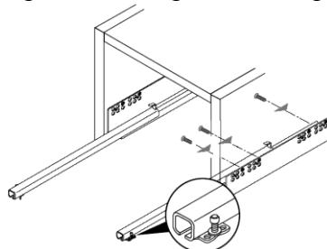
2. На планках *A.19, A.20* в отверстия диаметром 15 мм установить эксцентрики Rastex 15/16 (низкие), таким образом, чтобы стрелка была повернута в сторону кромки.
