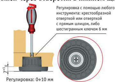
Регулировка с помощью любого инструмента: крестообразной отверткой или отверткой с прямым шлицом, либо шестигранным ключом 6 мм
