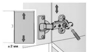
Слегка ослабить крепёжные винты монтажной планки. Отрегулировать положение двери по высоте. Крепёжные винты снова затянуть.
