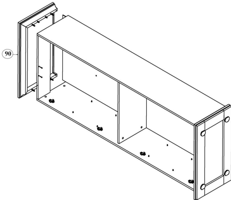
5. Собранный корпус проверить на прямоугольность, сравнивая диагонали (их длины должны быть равны). Прямоугольное положение корпуса зафиксировать, установив уголки мебельные с шурупом. Места соединения задних стенок закрепить шурупами 3x20 через скрепки.
