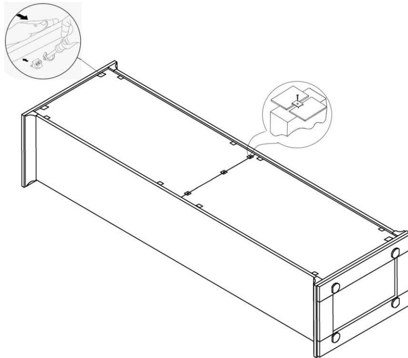
6. Установить корпус шкафа на место. Регулировка высоты опор осуществляется через отверстия в нижнем щите любым из трех инструментов: отвертка шлиц/крест или шестигранный ключ 6мм.
