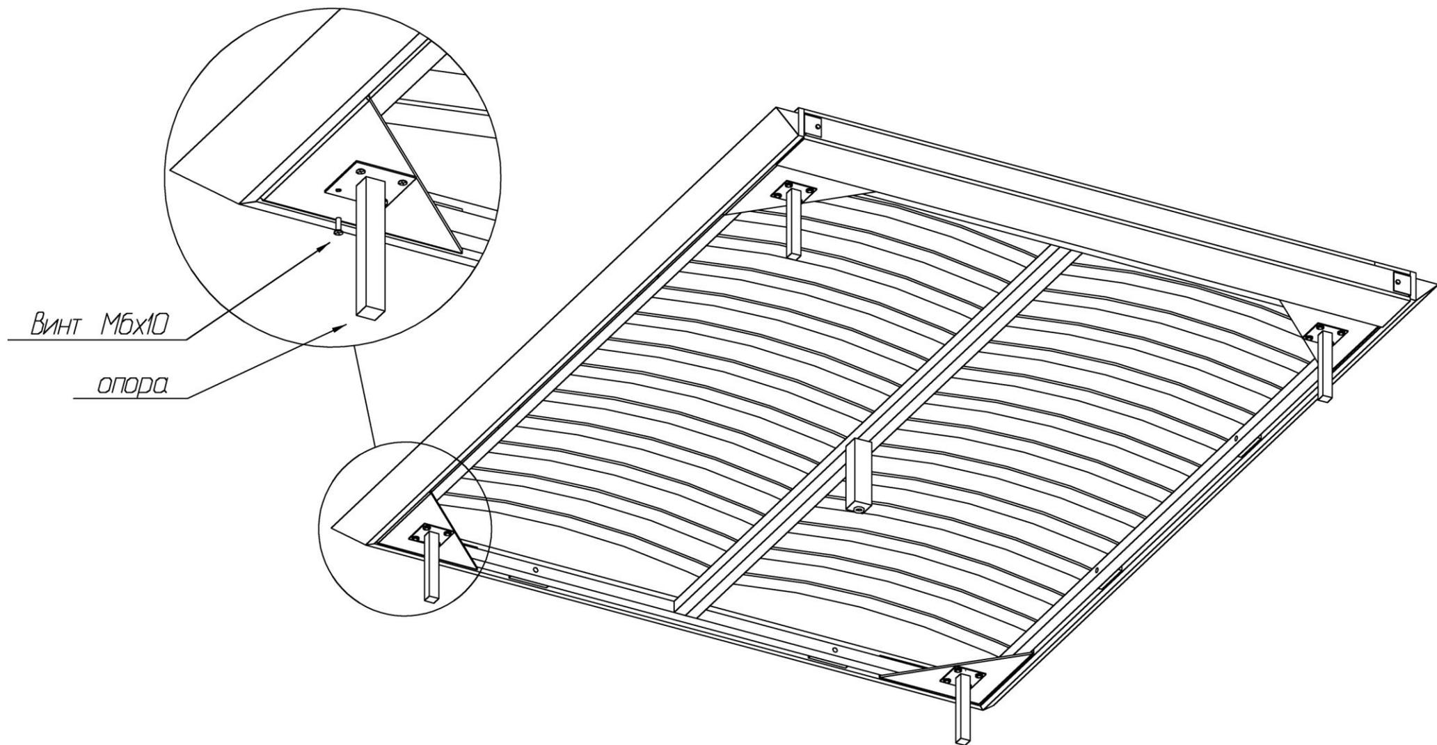
6. Установить центральную опору, закрепив ее с помощью винта М8х60 к раме основания.
